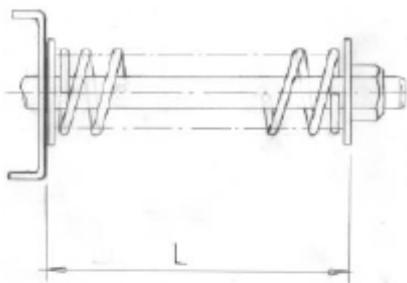
Vérifiez les réglages du système de sécurité mécanique du convoyeur, qui doit être ajusté en fonction de la longueur totale de l'appareil et des tables de sortie.
